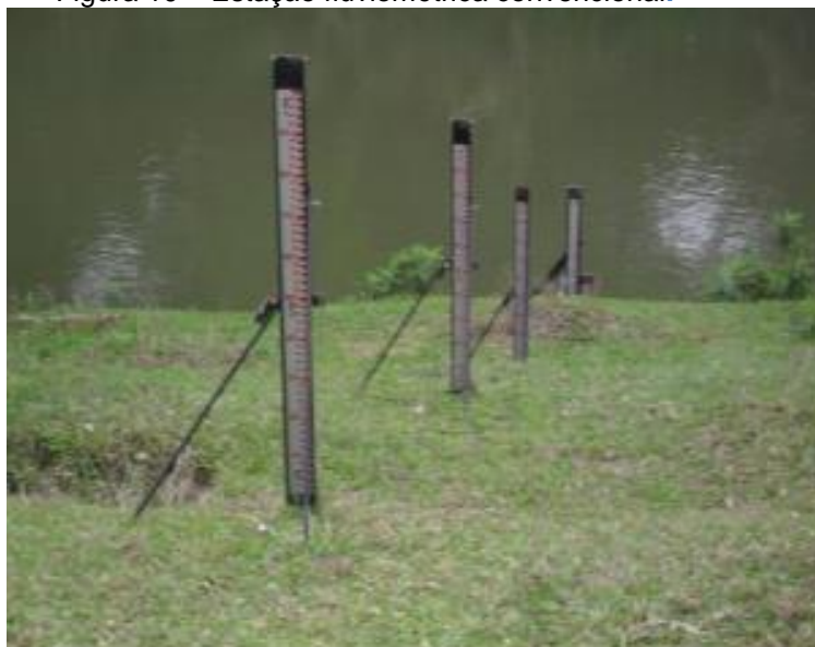
Figura 10 – Estação fluviométrica convencional.
