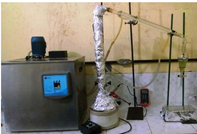
**Figura 4.3** – Aparato experimental de destilação fracionada.
