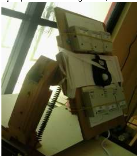
Figura 100 - Sistema de inclinação para testes de regressão, hobos U12 em medições simultâneas.
