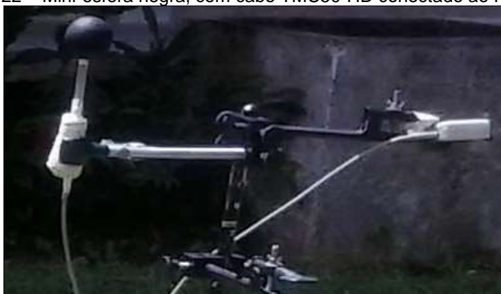
Figura 22 – Mini-esfera negra, com cabo TMC50-HD conectado ao Hobo H8
