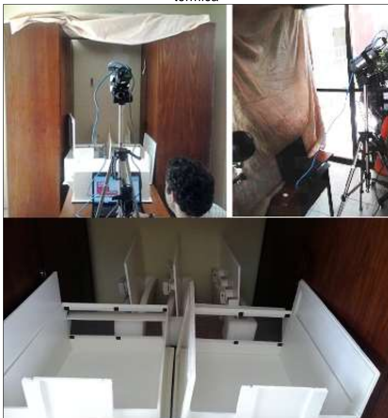
Figura 27 – Adaptação de câmara de resfriamento para os sensores e os modelos nos experimentos de térmica
