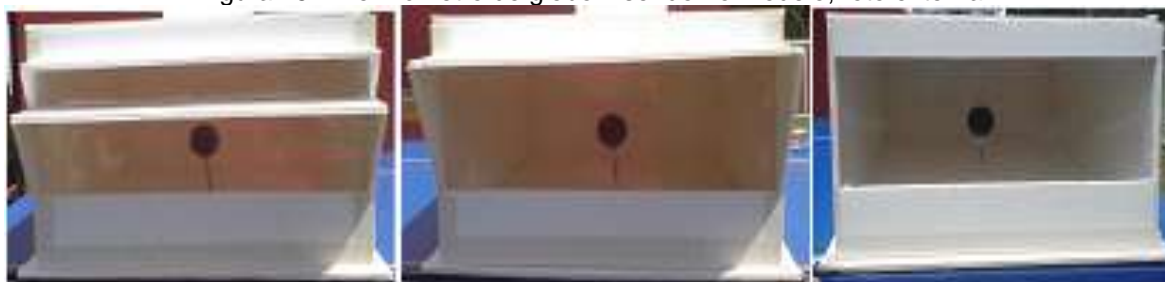
Figura 75 – Termômetro de globo inserido no modelo, foto externa
