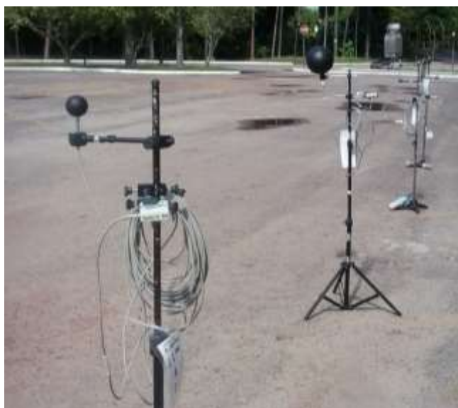
Figura 69 - Medição para regressão dos termômetros de globo, com uma esfera negra tamanho padrão e as mini esferas negras confeccionadas
