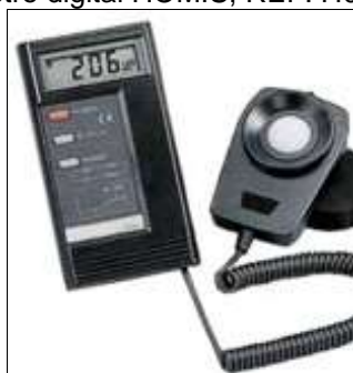
Figura 16 - Luxímetro digital HOMIS, REF: H019-005 | MOD: 204
