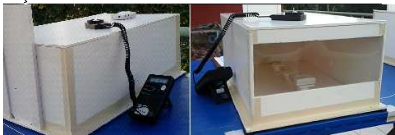
Figura 122 - Medições de iluminâncias internas e externas com luxímetro HOMIS e hobos U12
