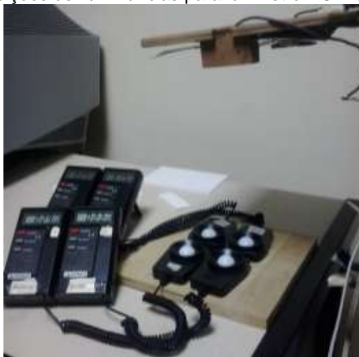
Figura 132 - Medições de iluminâncias para luxímetro HOMIS com luz artificial
