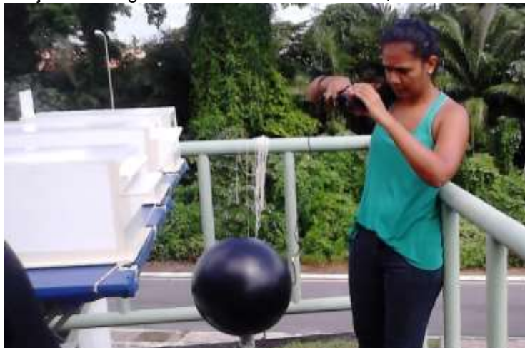
Figura 151 - Obtenção da imagens IFR frontais dos modelos, com a câmera FLIR I60 portátil.
