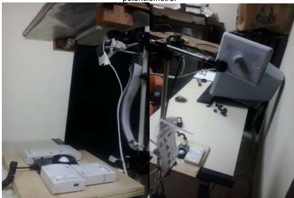
Figura 108 - Medição de Iluminância para luz artificial com hobos U12, à esquerda e a direita o potenciômetro.
