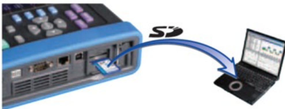
Figura 4.7 – Transferência dos dados por cartão SD do analisador de QEE para o computador.
