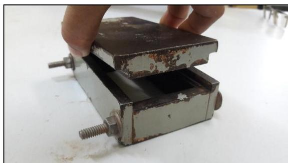
Figura 3.4 - Matriz de aço utilizada na conformação das massas argilosas.
