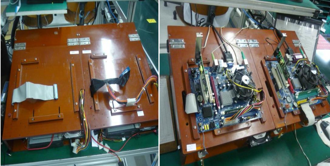
Figura 27 – Dispositivo para teste em duas placas independentemente (a e b respectivamente)
