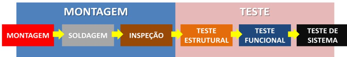
Figura 14 - Inspeções e testes (Adaptado de ASSET in *Board Test Strategies*)
