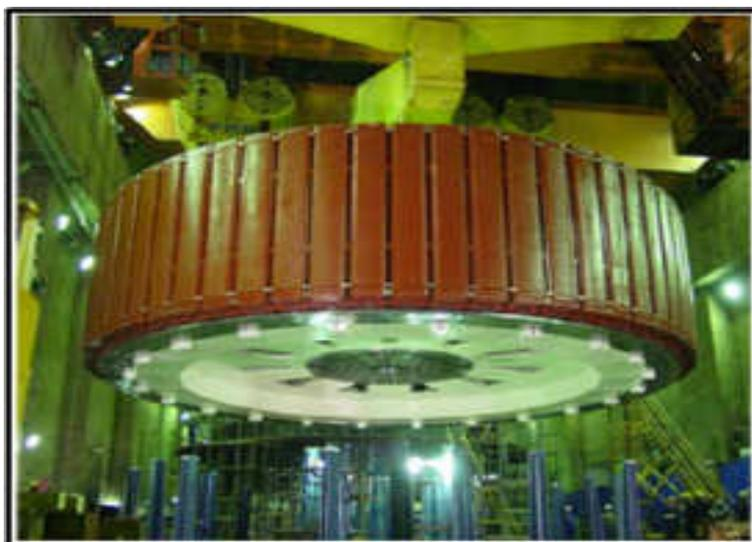
**Figura 2.2:** Rotor de um Hidrogerador
