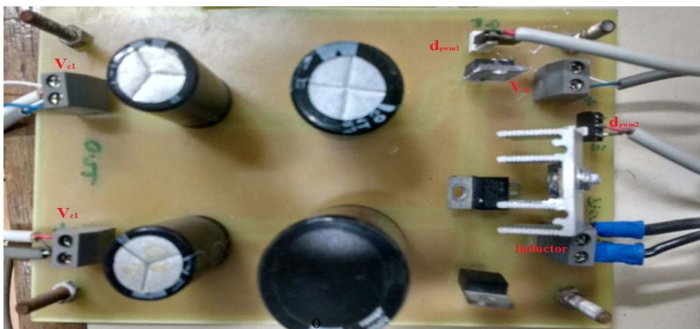
Figura 5.5. Sistema do conversor SIMO.
