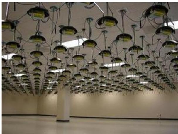
Figura 11: Ambiente Experimental Sem Fio ORBIT.
