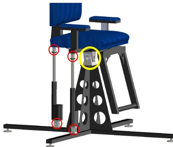
Figura 23. Juntas lineares do desenho do protótipo.
