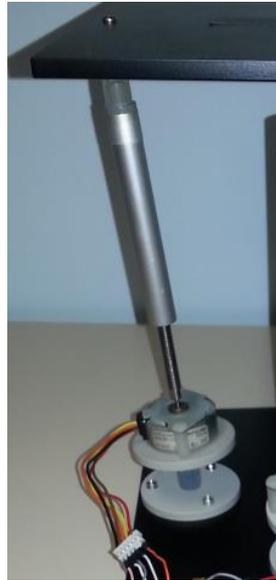
Figura 7. Atuador linear usando motor de passo.
