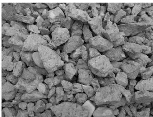
Figura 3.14 - Mistura final de agregado graúdo reciclado de concreto
