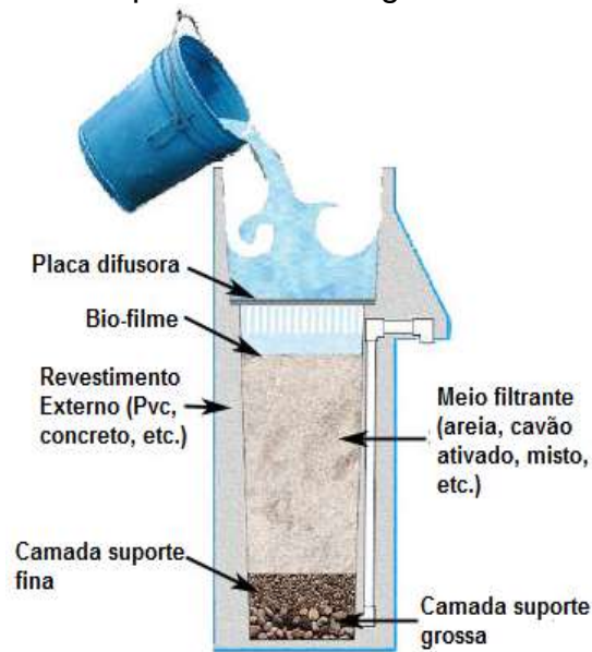
Figura 5 – Exemplo de filtro de água da chuva.
