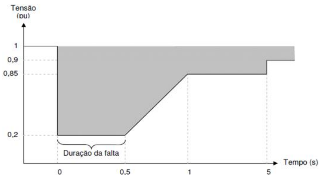
Figura 3.1 - Curva de capacidade de sobrevivência a afundamentos de tensão
