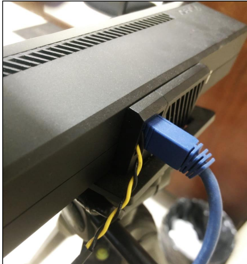
Figura 14. Sistema de adaptação do Kinect Xbox One para uso em desktop.
