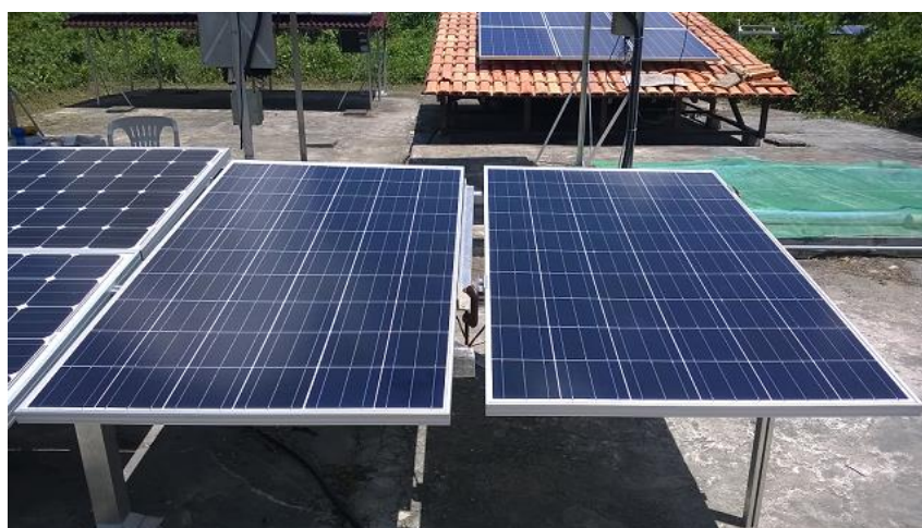
Figura 2.18 – DUT e módulo de referência de mesmo modelo na área de teste.
