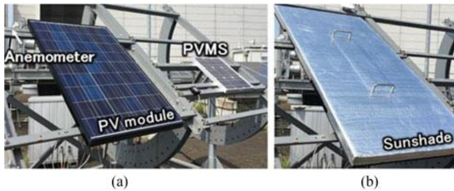
Figura 1.16 – Aparato experimental para técnica de sombreamento: (a) Sem sombreamento (b) Com sombreamento.
