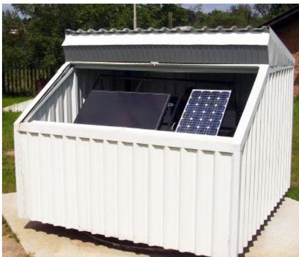
Figura 1.13 – Câmara climatizada desenvolvida no laboratório da UFRGS.
