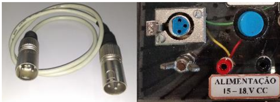
Figura 2.6 – Interconexão entre as cargas capacitivas: (a) Cabo de três vias com conector XLR 24 e (b) Detalhe do conector fêmea XLR 24 na carga capacitiva e terminais de alimentação.
