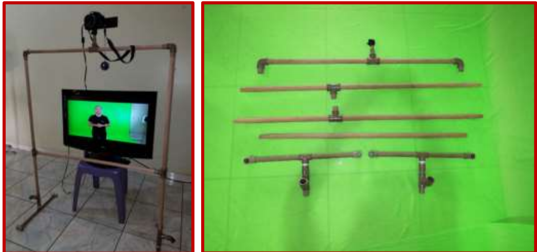
Figura 5 - Tripé para a câmera digital montado e desmontado
