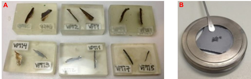
Figura 28 - Amostras preparadas para o MEV (A), embutidas em resina de poliéster; Amostra pulverizada para ensaio de DRX (B).
