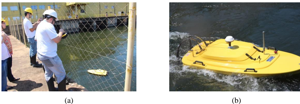
Figura 5.23 Equipe da AES Tietê medindo profundidades com ADCP no Q-boat.
