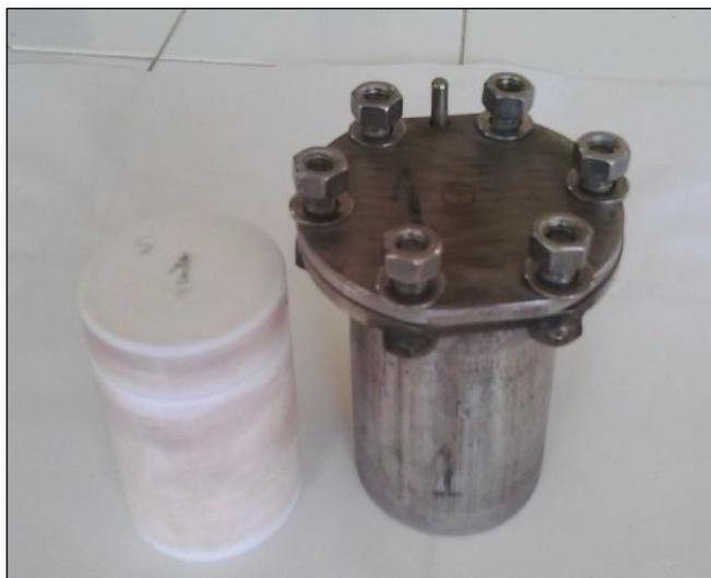
Figura 4.1: Reatores de aço inoxidável utilizados. (Fonte: Autor).
