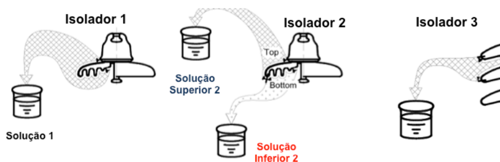
Figura 11: Método de coleta de DDES e DDNS na superfície dos isoladores de disco padrão.
