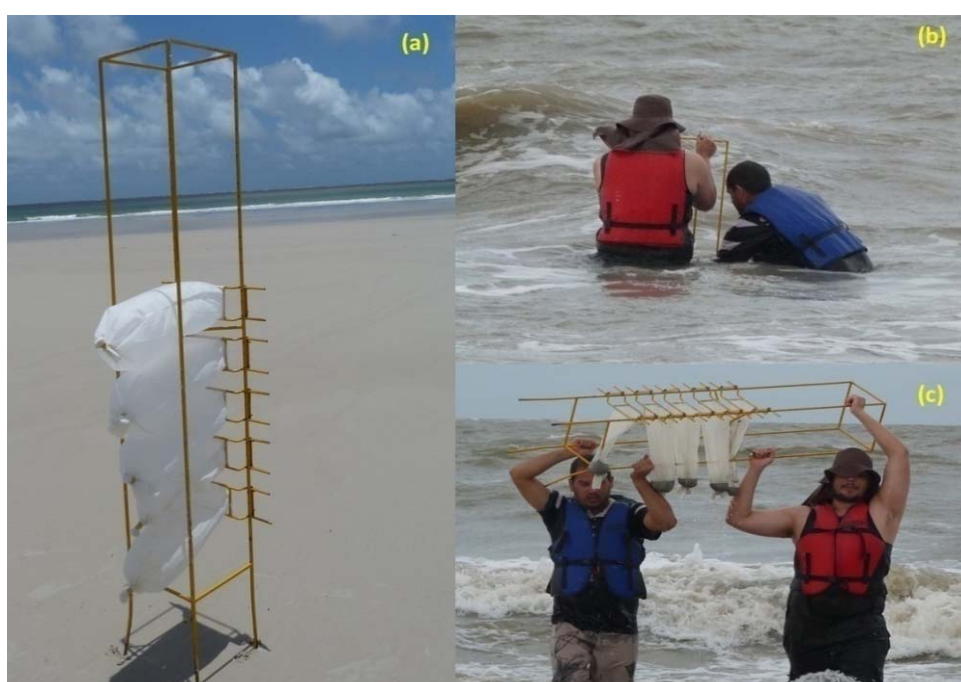
Figura 13: Fixação do trapeador portátil (a), fixação do aparelho (b) e sedimentos coletados (c).
