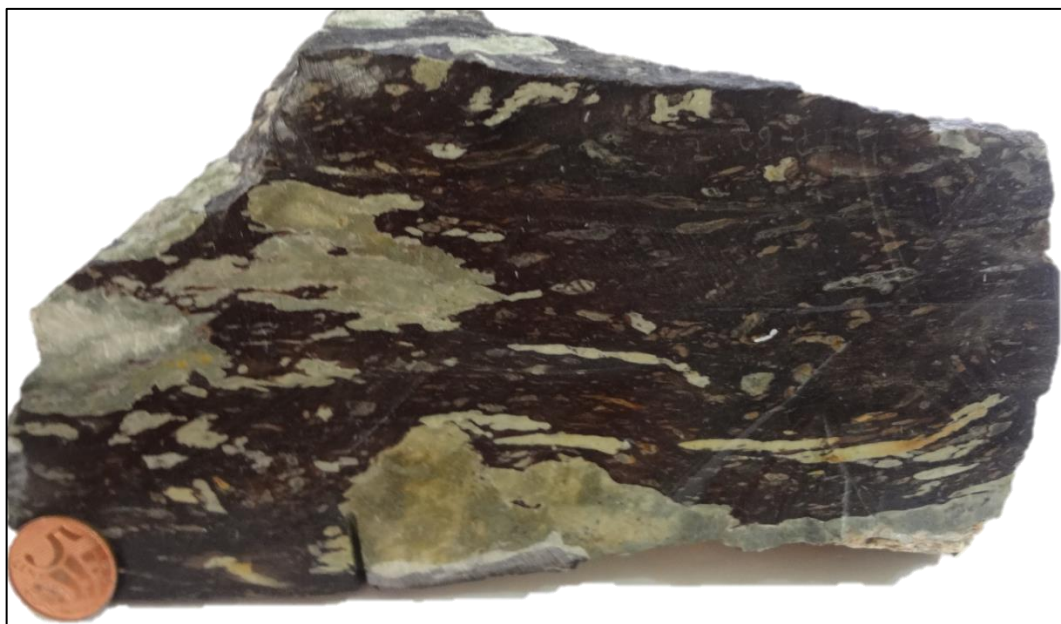
Figura 3.12 – Rocha metavulcanossedimentar composta por matriz muito fina e fragmentos de rocha de formas alongadas constituindo uma foliação de fluxo.
