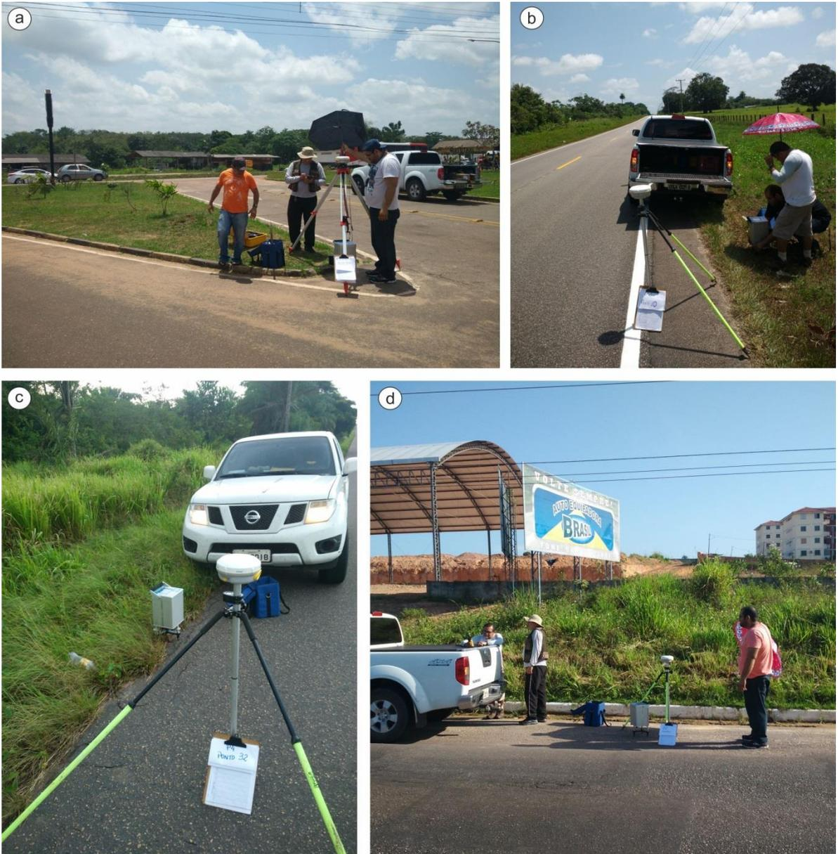
Figura 2.9 - Coleta de dados gravimétricos e de DGPS em campo.
