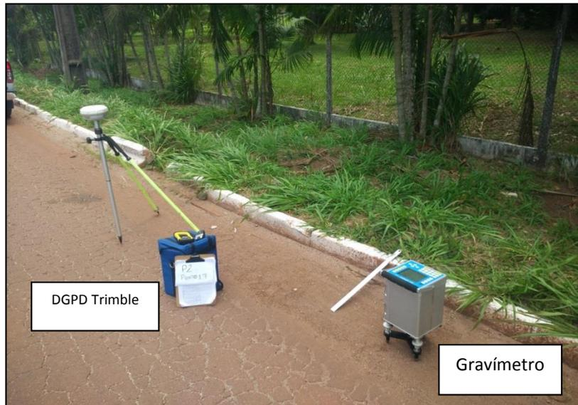
Figura 2.7 - Equipamentos utilizados na aquisição dos dados gravimétricos: Gravímetro Scintrex CG5 e DGPS Trimble.
