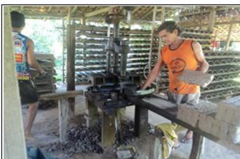
Foto 13 – Fabricação manual de telhas
