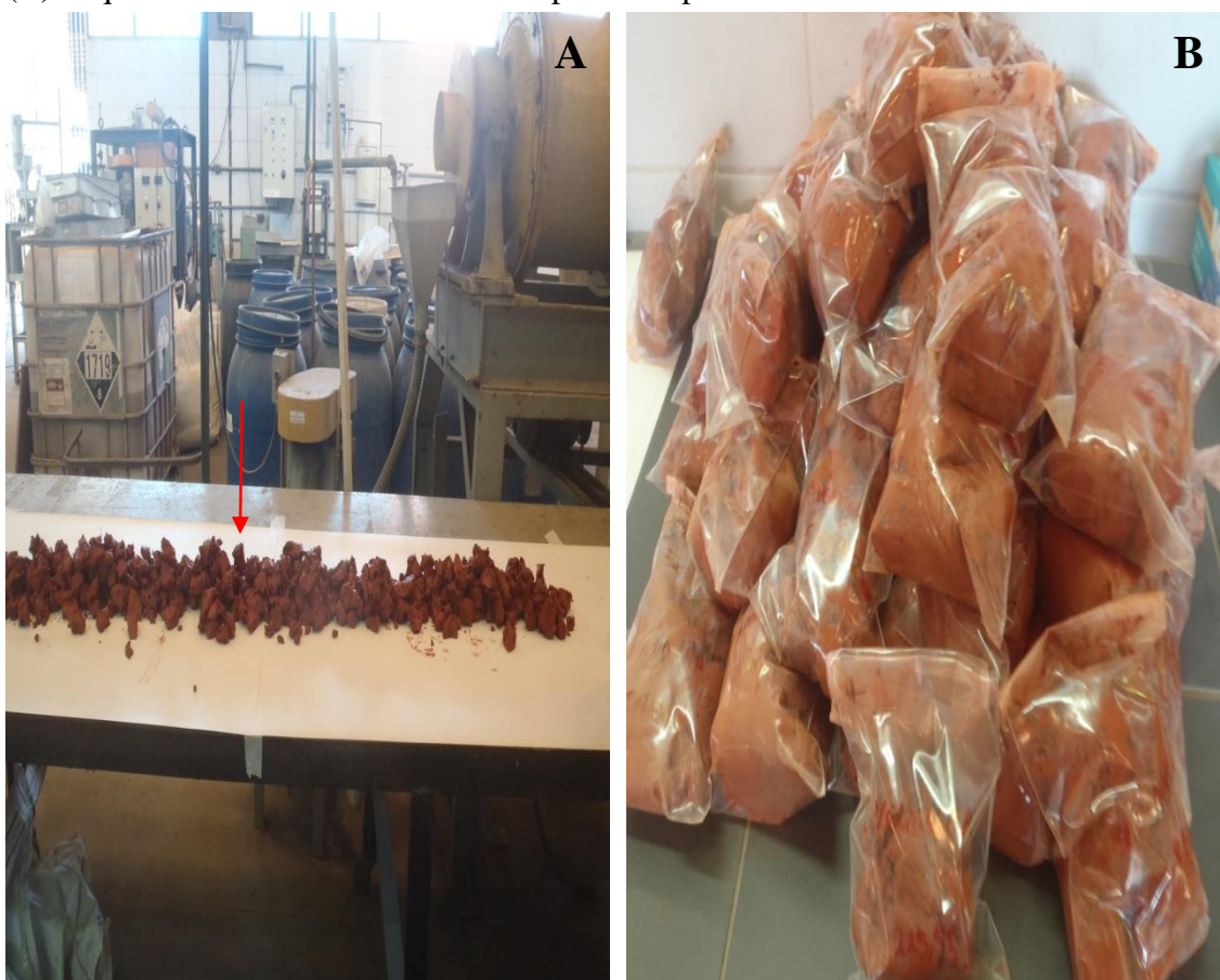
Figura 9 – Amostra de Lama Vermelha. (A) montagem de pilha de homogeneização; (B) alíquotas acondicionadas em sacos plásticos para ensaios em laboratório.
