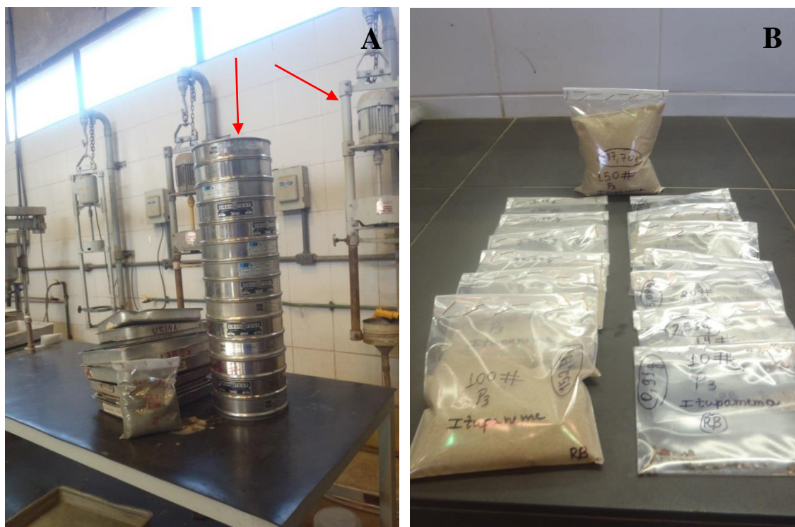
Figura 10 – Procedimento de classificação granulométrica das amostras de sedimento (A) série de peneiras (Tyler) e peneirador vibratório ado fundo; (B) frações granulométricas da amostra de sedimento.
