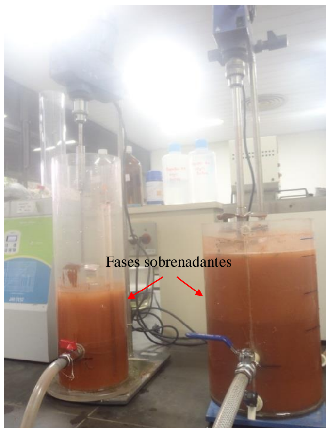
Figura 11 – Repolpagem da lama vermelha em tanque agitado, para retirada do sobrenadante.
