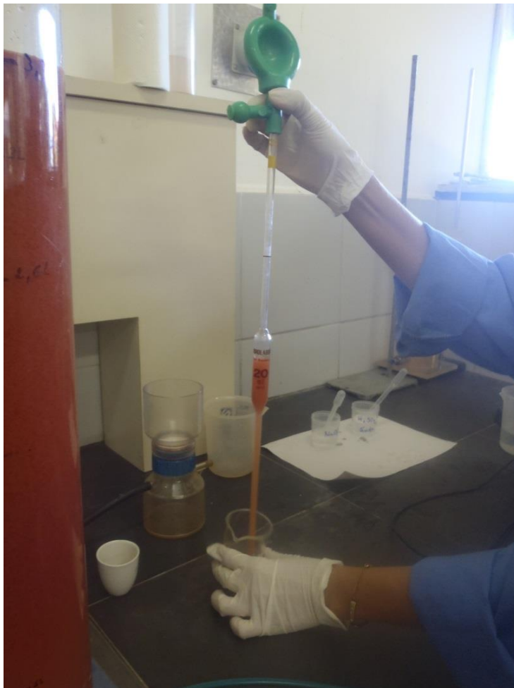
Figura 13 – Coleta de amostra do efluente para a determinação da porcentagem de sólidos, antes do tratamento por FAD.
