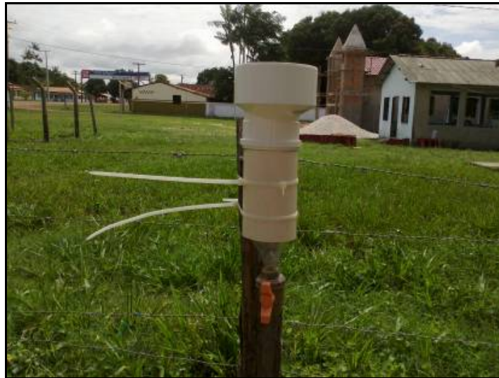
Figura 4- Pluviômetro artesanal, adaptado com garrafa pet.
