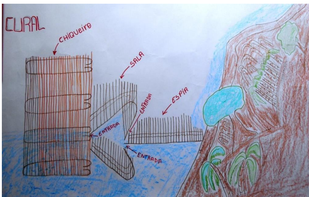
Figura 11: Desenho esquemático da técnica de pesca por curral. Desenho elaborado por Adilson Cássio S. S., 24 anos, morador do quilombo Bairro Alto.
