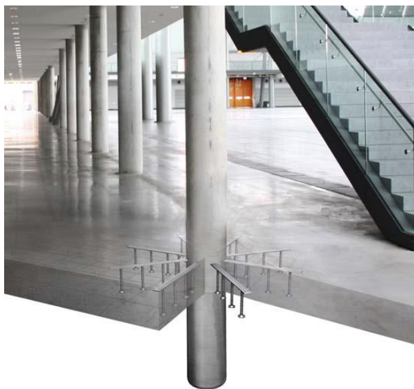
a) Distribuição das armaduras na ligação laje-pilar
