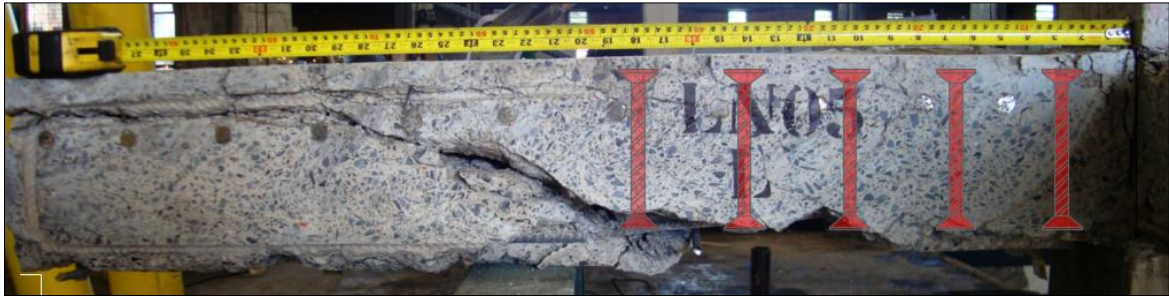
Figura 2.15 – Ruptura por punção com superfície de ruptura externa à região das armaduras (Adaptado de OLIVEIRA, 2013)
