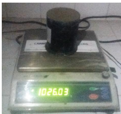
Figura 3.11 – Ensaio de densidade de massa. Fonte: autora
