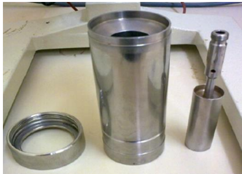
a) Conjunto cilindro coaxial: copo SV e spindle SV 1
