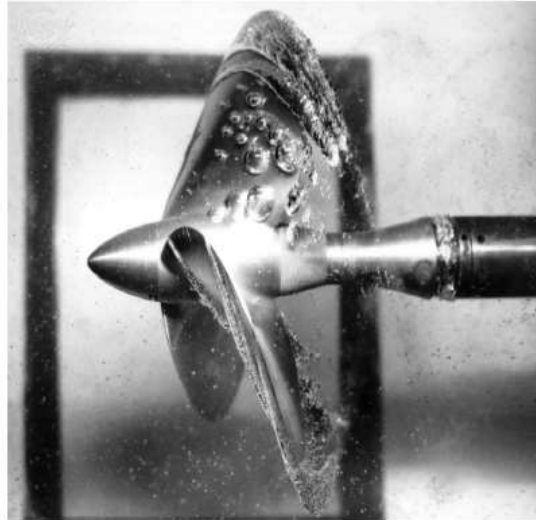
Figura 4.1: Formação de cavitação em um propulsor (Franc e Michael, 2006).
