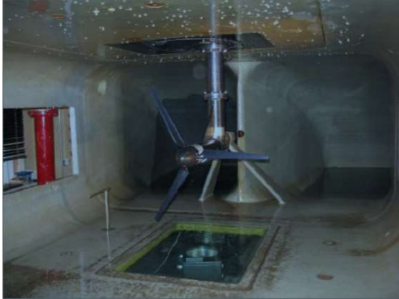
Figura 1.3: Turbina hidrocínética em túnel de água - Universidade de Southampton (Molland et al. , 2007).
