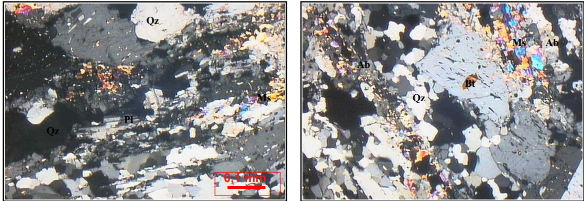
Figura 5.10: Fotomicrografias em NX de amostra de xisto albitizado: a) Formas dos cristais de quartzo, plagioclásios, por vezes fortemente sericitizados, e muscovita; b) Alternância de bandas mais rica em quartzo e outras mais ricas em albita e muscovita com inclusões de biotita plagioclásio.
