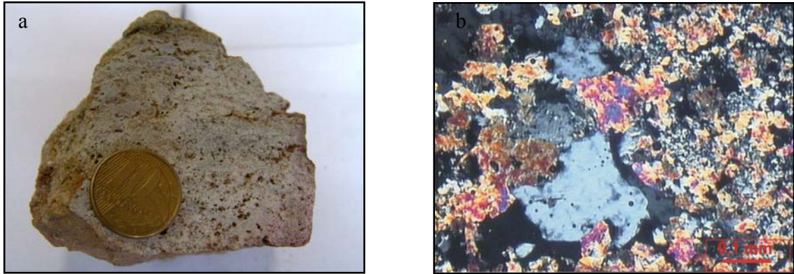
Figura 5.38: Rocha greisenizada encontrada no setor de Água Branca (AB6a): a) Foto de amostra de mão com cavidades de dissolução; b) Fotomicrografia em NX mostrando as feições microscópica com abundante muscovita associada a quartzo.
