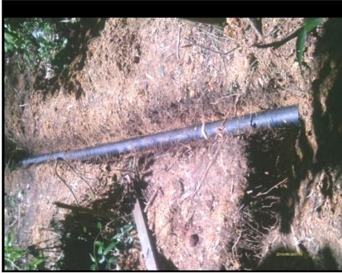
Figura 7: Tubo em “V” (duas peças de 6 m) enterrado transversal aos perfis no Campo de Testes.
