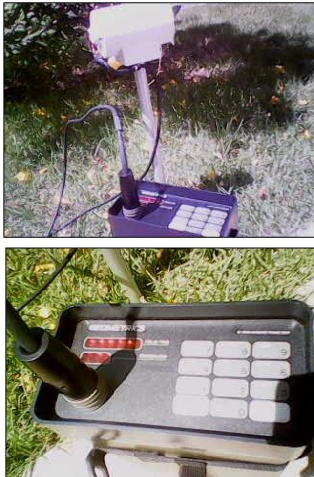
Figura 19 – Medidas de Magnetometria no Perfil 2: Sensor a 0,6 m do solo, sensor a 1,2 m do solo e medidas a 1,2 m do solo antes da inserção dos artefatos.
