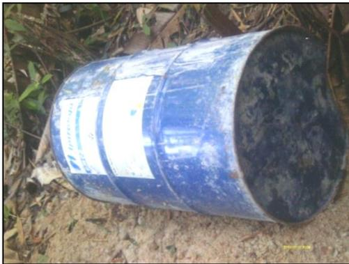
Figura 9: Tambor plástico de 96 cm de comprimento por 60 cm de diâmetro enterrado perpendicular aos perfis no Campo de Testes.
