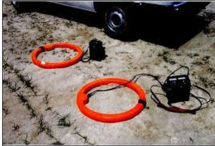
Durante as medidas as bobinas foram dispostas nas configurações coplanar horizontal e coplanar vertical (Figura 17).
