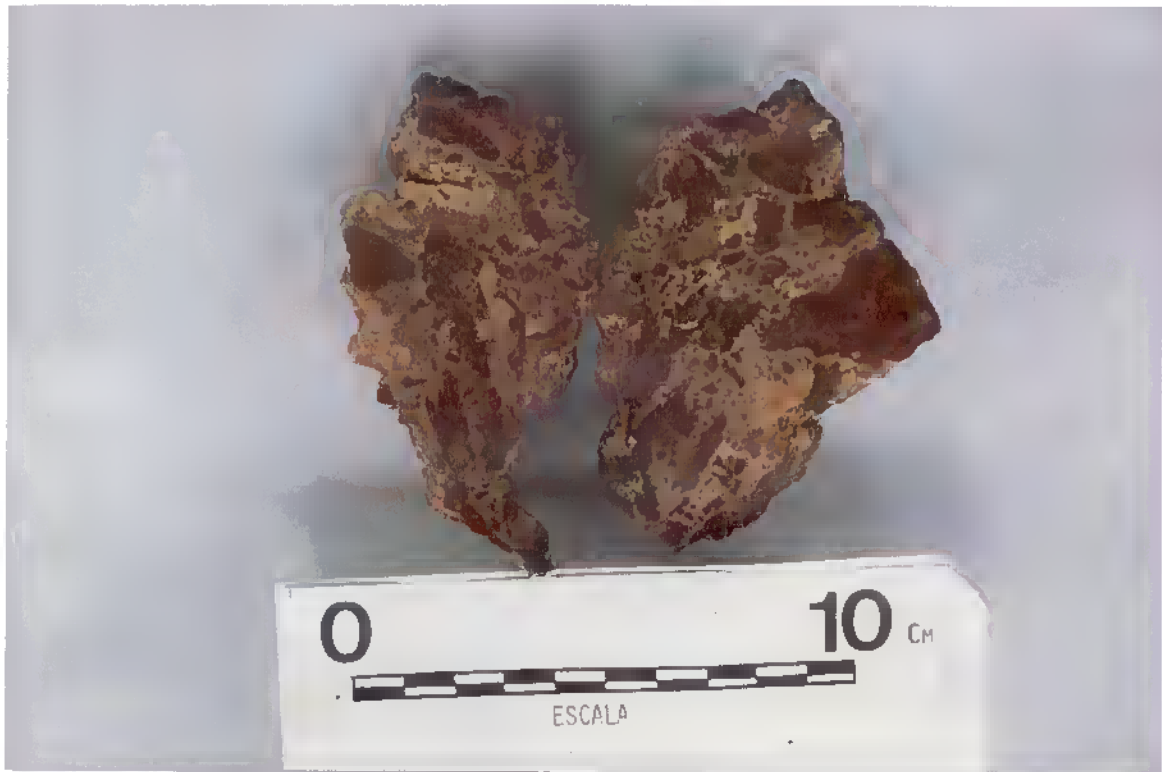
Figura 37- Textura brechóide dos nódulos lateríticos, horizonte nodular do perfil A
