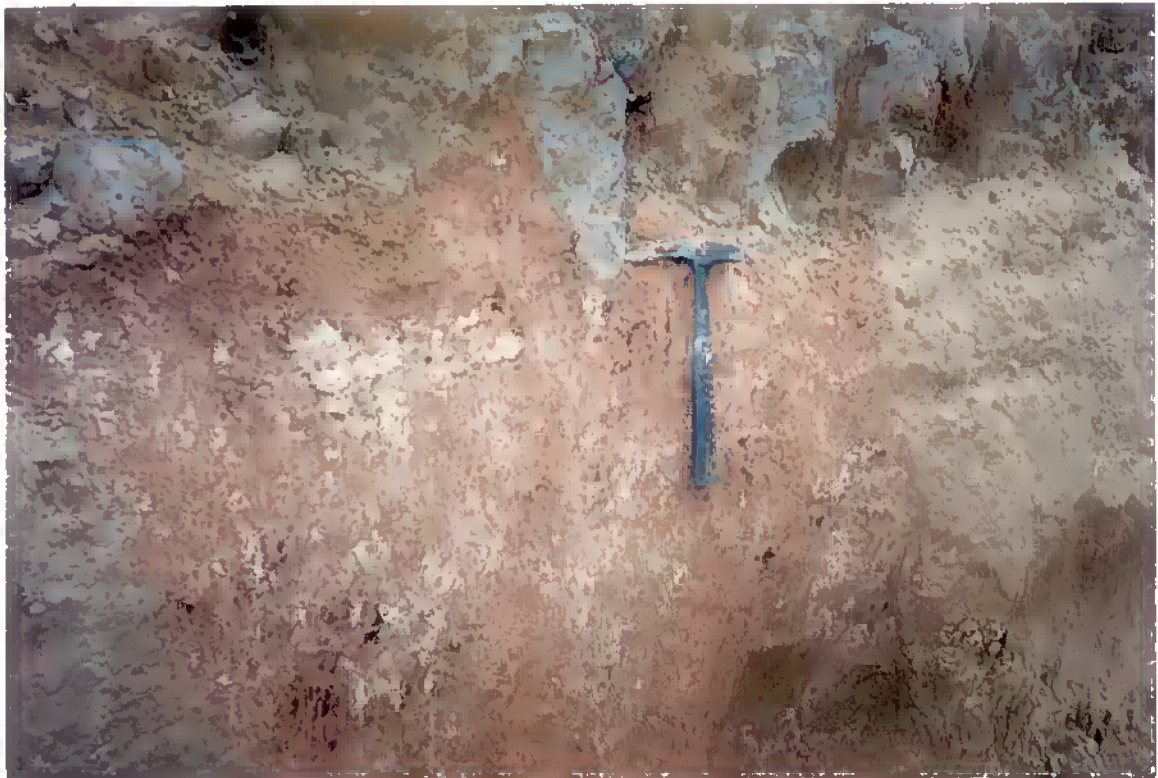
Figura 31 - Crosta laterítica colunar com cavidades subverticais preenchidas por argila e zona de transição para o Caulim Superior.
