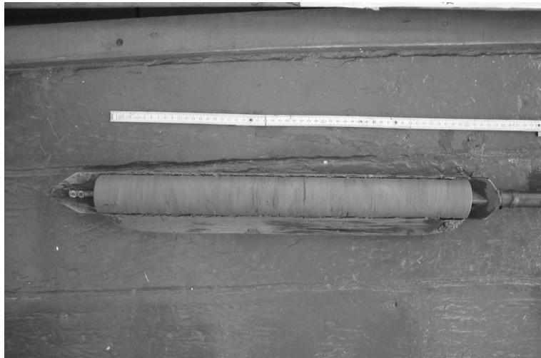
Figura 7 – Testemunhador russo com amostra de testemunho coletado.
