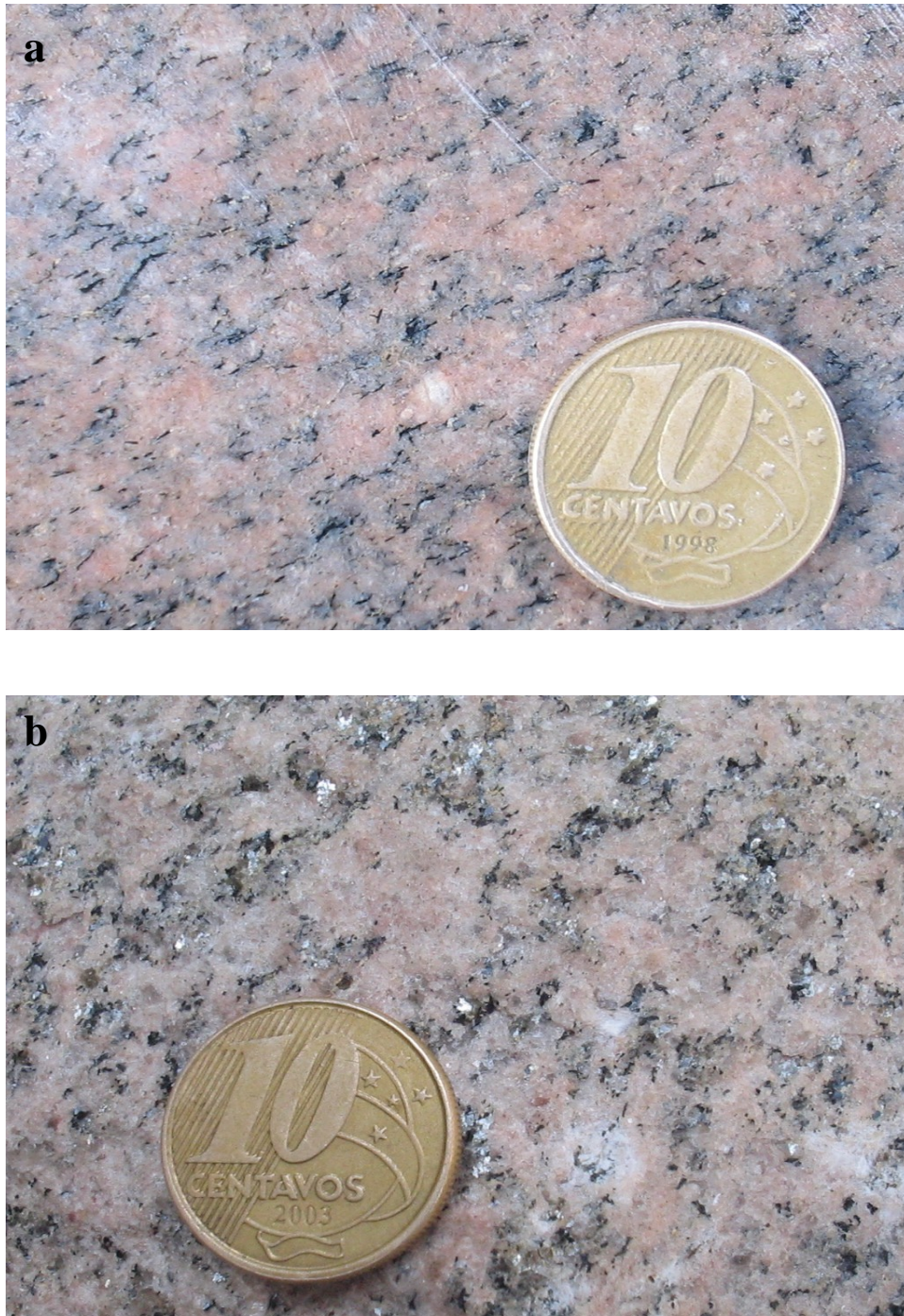
Figura 5.3- Aspectos macroscópicos do Granito Ramal do Lontra, onde destaca-se a foliação mais intensa evidenciada principalmente pela orientação das lamelas de biotita. a) Amostra RL-02 e b) Amostra EXA-VIII-13.
