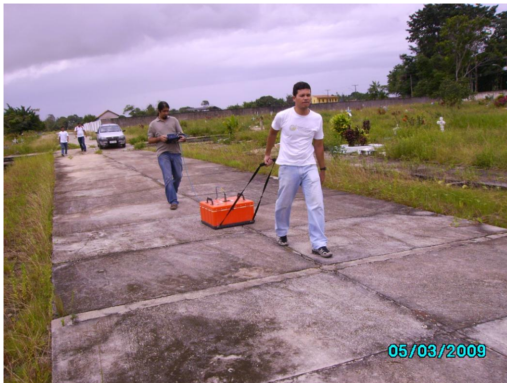
Figura 5.5 – Aquisição de dados de GPR no cemitério do Tapanã, perfil na passarela principal (cimento).
