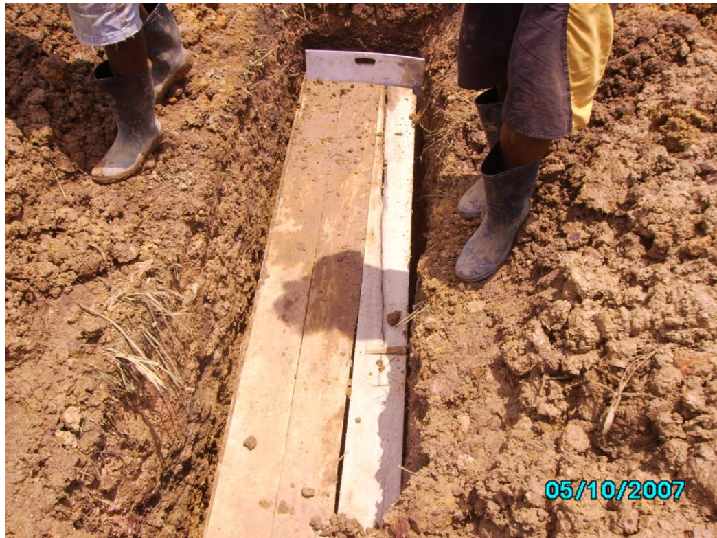
Figura 3.5 – Caixa simulando túnel no campo de teste FORAMB.
