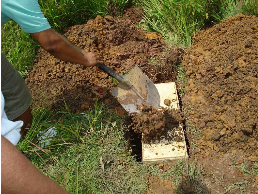
Figura 3.6 – Caixa com metais simulando armas enterradas no campo de teste FORAMB.
