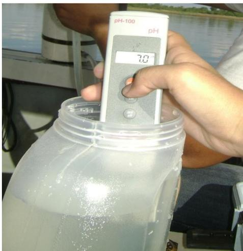
Figura 19 - Determinação do pH da água.
