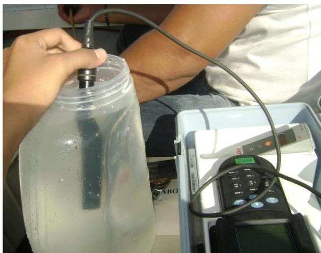
Figura 20 - Determinação da condutividade elétrica da água.
