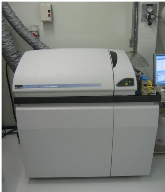
Figura 22 - Espectrometria de massa com fonte de plasma de Argônio induzido (ICP-MS) modelo Elan DRC II (Perkin-Elmer, Norwalk, CT).
