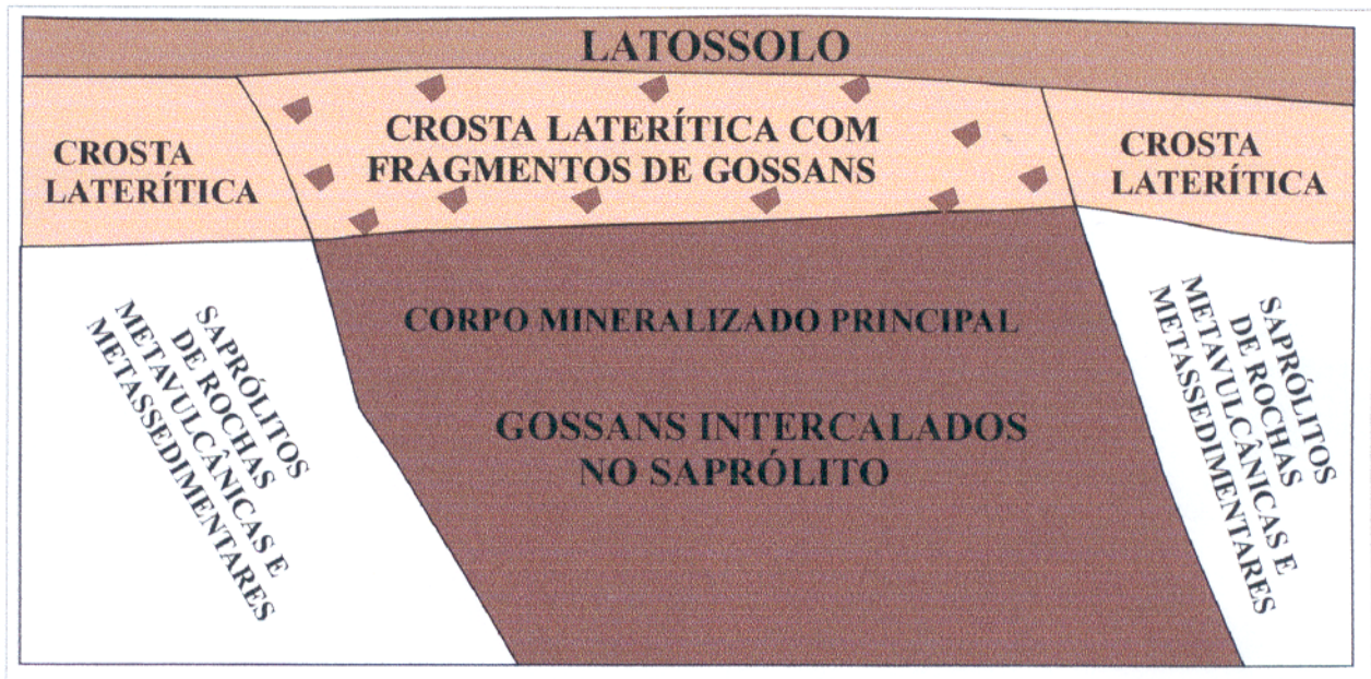
Figura 4 - Perfil esquematizado da mineralização aurífera de Igarapé Bahia.
