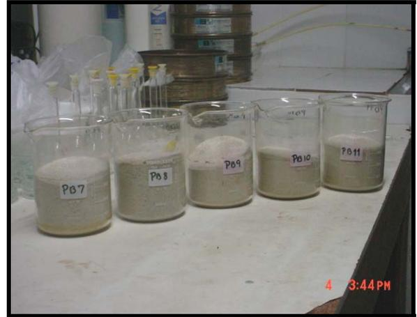
**Figura 11 – Amostras de sedimentos arenosos lavadas em água destilada (Foto do autor).**
