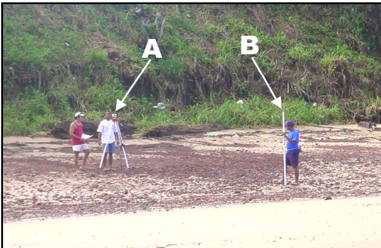
**Figura 5 – Método de levantamento topográfico da “*Stadia*” (Birkemeier, 1981). Este método utiliza um nível automático (A) e uma régua graduada escalonável (B). Praia dos Artistas em Junho/2004 (Foto do autor).**
