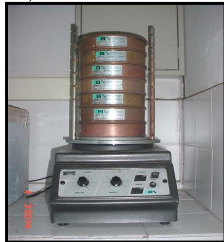
**Figura 13 – Peneirador e jogo de peneiras utilizados para a separação por vibração mecânica, das classes granulométricas dos sedimentos arenosos (Foto do autor).**
