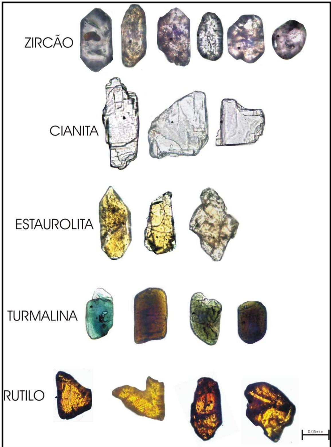
Figura 71–Minerais Pesados identificados nos sedimentos arenosos da Falésia localizada na margem direita da Praia do Amor (Foto de Anderson Conceição Mendes).
