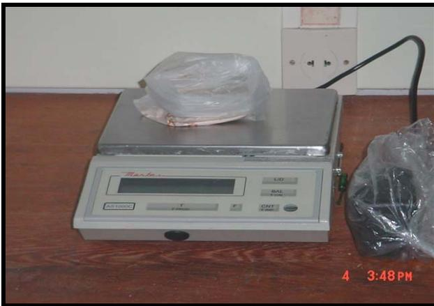
**Figura 12 – Balança utilizada para a pesagem dos sedimentos arenosos (Foto do autor).**
