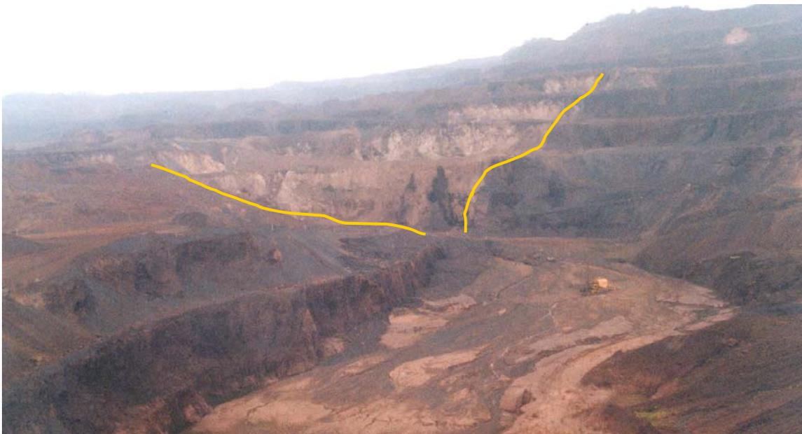
**Figura 4.5** – Contato por falha na cava norte da Mina N4E. As falhas (linhas laranja) N-S (esquerda) e NE-SW (direita) limitam um bloco de rocha vulcânica. Localização: seção 22.
