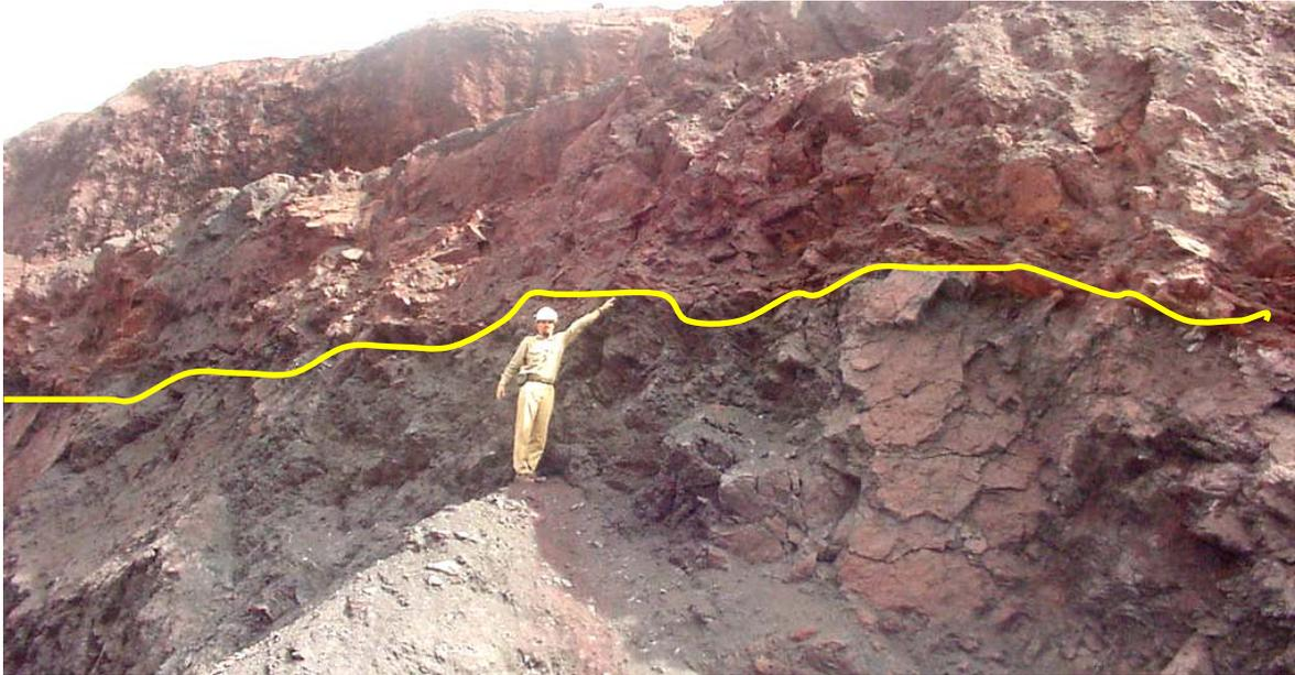
**Figura 4.2** – Contato concordante, sub-horizontal, entre rocha vulcânica (superior) e rocha ferrífera inferior na Mina N5W (Foto CVRD-GAJAN).
