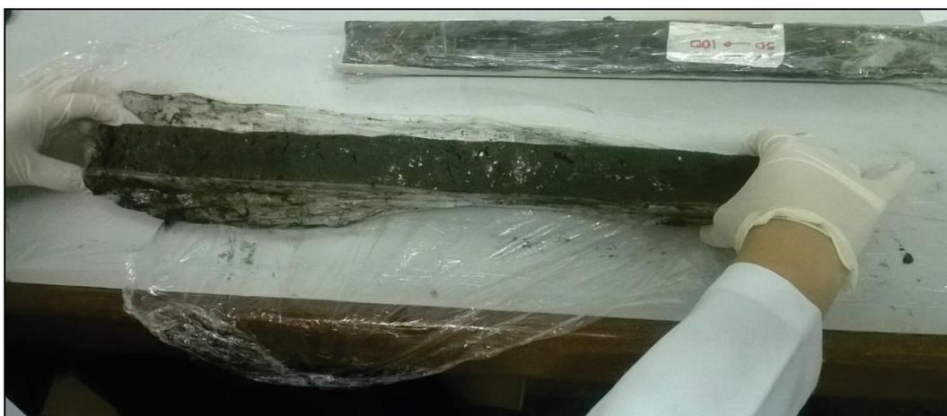
Figura 10 – Abertura do testemunho armazenado em tubo e filme PVC para evitar contaminação.
