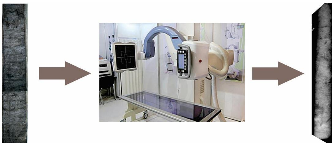
Figura 11 – Fotografia e radiografia de uma seção testemunho MBN nos mesmos intervalos para observação de suas estruturas sedimentares.
