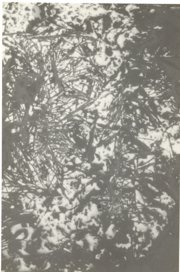
Figura 41 - Textura "durchbewegung" desenvolvida durante o metamorfismo regional, quando parte dos sulfetos (cinza claro) foram injetados ao longo dos planos de clivagem dos anfibólios (cristais fibrosos). Unidade II, Corpo 4E/Pojuca, Serra dos Carajás. Aumento: 200 X. Luz refletida, nicóis paralelos.
