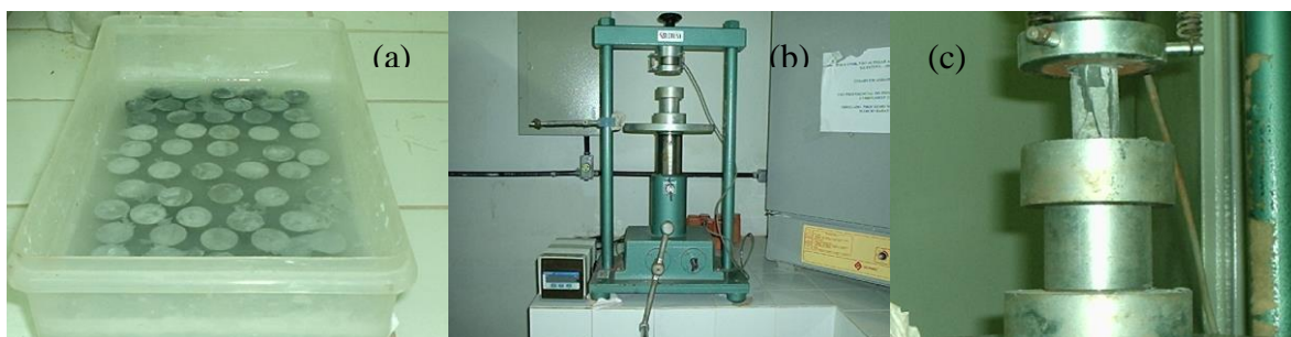
Figura 6 – Ensaio da Atividade Pozolânica (a) Cura (b) Prensa hidráulica e (c) Corpo de prova na prensa
