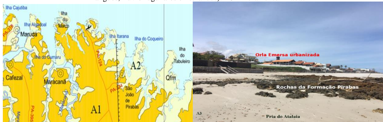
Figura 2.2- Principais formações geológicas da área de estudo: A1 (Grupo Barreiras: arenito e conglomerado, intercalações de siltito e argilito); A2 (Depósitos flúvio-marinhos indiscriminados de pântanos e mangues, flúvio-lagunares e litorâneos). A3 Afloramento Pirabas
