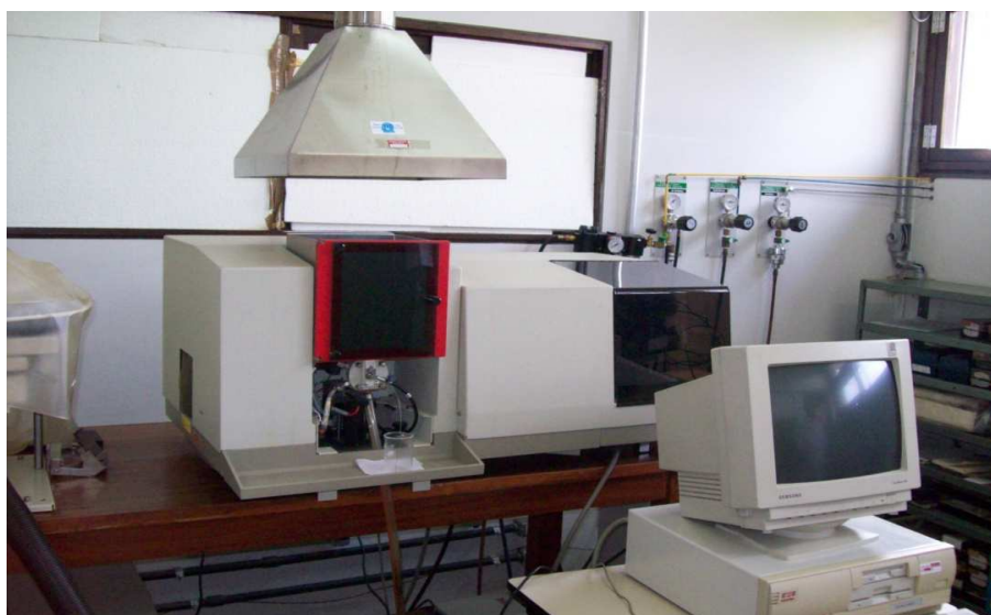
Figura 18. Espectrômetro de Absorção Atômica utilizado na leitura da concentração dos elementos maiores e traço
