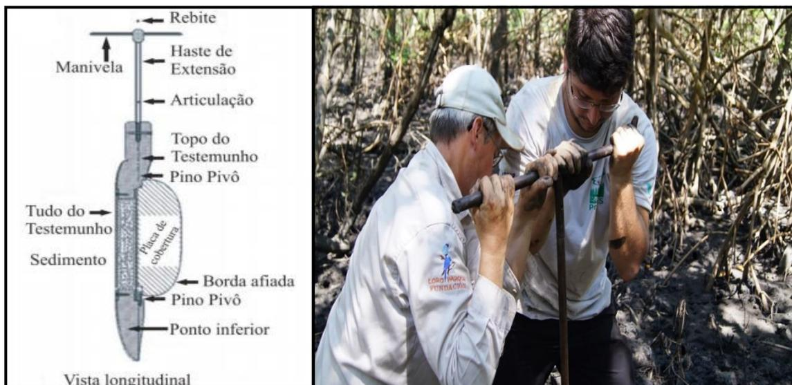
Figura 10- Amostrador do tipo Trado Russo utilizado na amostragem dos testemunhos URU1 e URU2.
