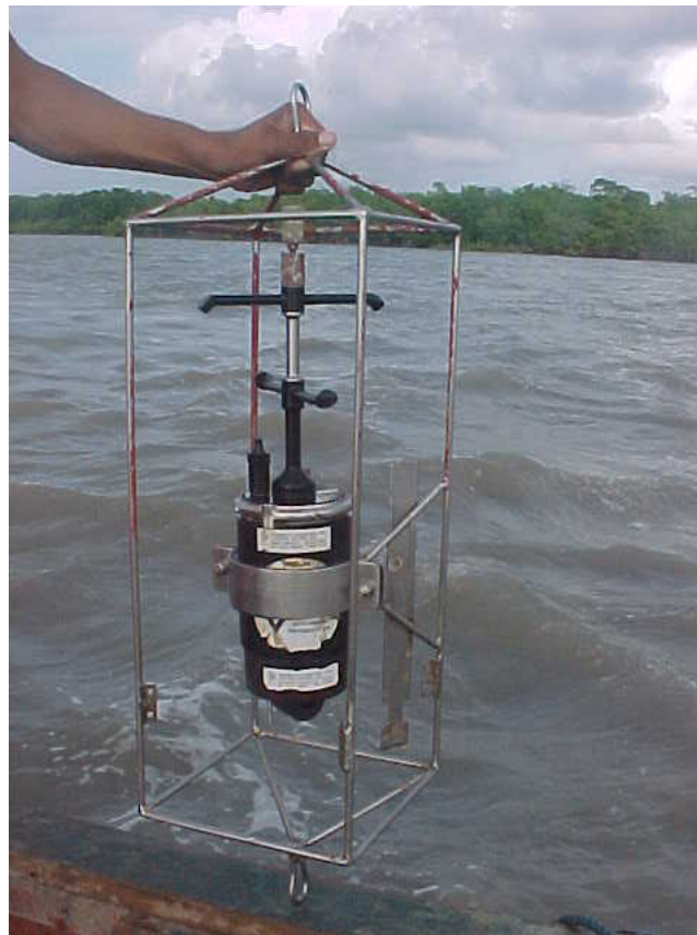
Figura 34: Correntógrafo da marca Falmouth Scientific Inc. modelo 2D ACM.
