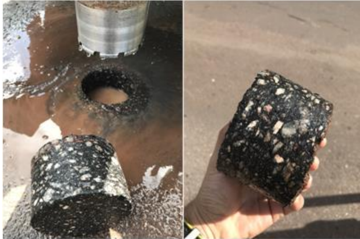
Figura 4.22 - Extração de corpo-de-prova em campo para ensaio de extração de betume.
