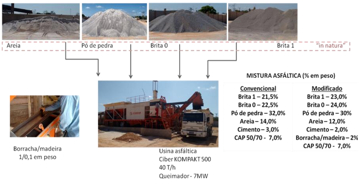
Figura 4.16 - Mistura asfáltica de asfalto com composto madeira/borracha.
