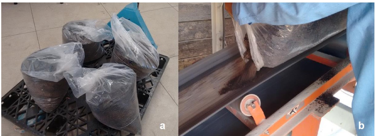
Figura 4.14 - Composto madeira/borracha: material em estoque (a); Composto madeira/borracha transportado através das correias da usina gravimétrica(b).
