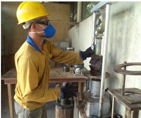
Figura 5.9 – Ensaio de estabilidade e fluência em corpo-de-prova de asfalto madeira/borracha.
