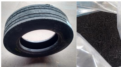
Figura 3.7 – Borracha reciclada de pneu moída utilizada na pesquisa.
