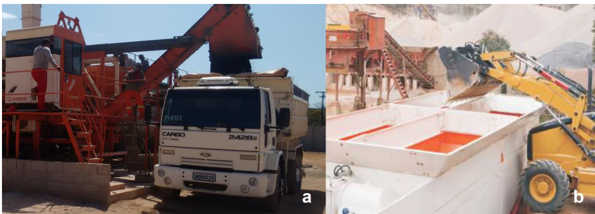
Figura 4.12 – Mistura asfáltica: usina de asfalto móvel CYBER, descarregamento de asfalto em caminhão basculante 6x4 (a); silos usina de asfalto Kompak 500 (b).
