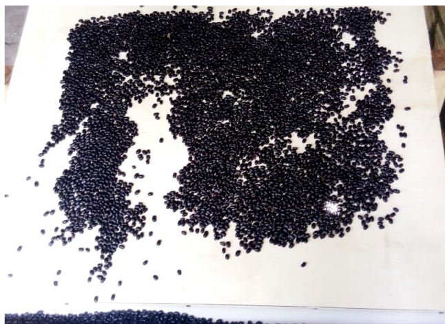
Figura 5.6: Experimento de avalanche de feijão recriado na mesa com inclinação de 15 graus.
