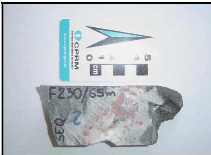
Figura 59 – Fotografia de testemunho de furo de sondagem de vênula de calcita em rocha máfica. F230/65m - corpo Sequeirinho.
