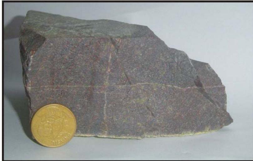
Figura 51 – Fotografia de amostra de dique félsico da frente de lavra, corpo Sequeirinho.
