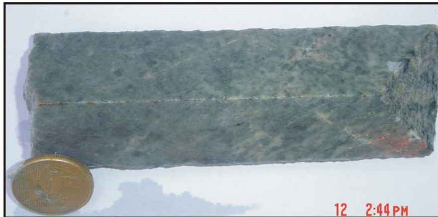
Figura 15 – Fotografia de testemunho de sondagem correspondendo à variedade porfírica dos granitóides. Amostra F-266/475, 1m, corpo Sequeirinho.
