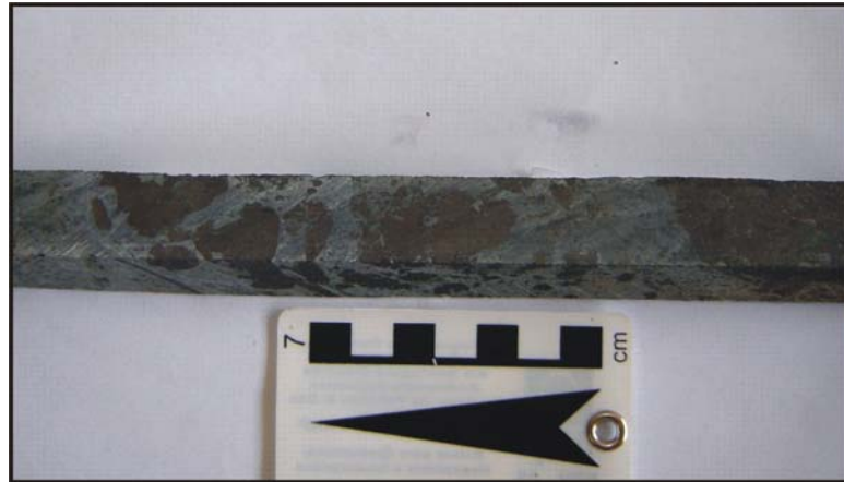
Figura 37 – Fotografia de furo de sondagem de magnetitito. (Furo F-204/122,1m – corpo Sequeirinho).
