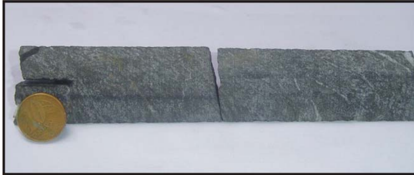
Figura 28 – Fotografia de testemunho de furo de sondagem de rocha rica em biotita levemente orientada. (Furo F-352/226,08m – corpo Sequeirinho).
