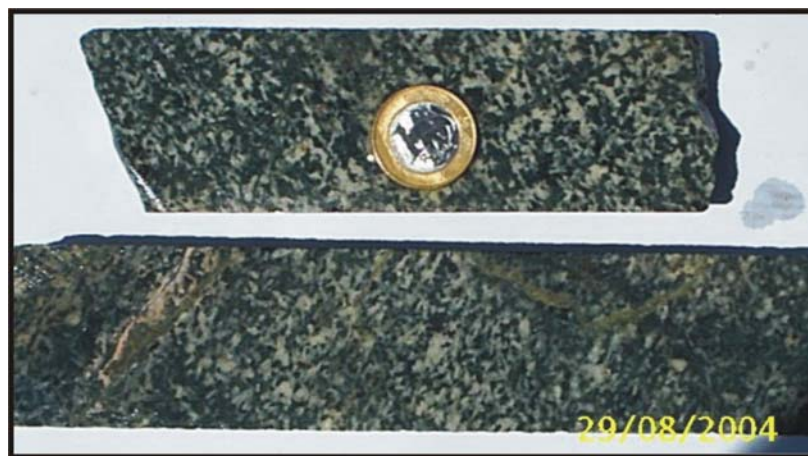
Figura 20 – Fotografia de testemunho de furo de sondagem de gabro pouco alterado. (Furo F-204 – corpo Sequeirinho).
