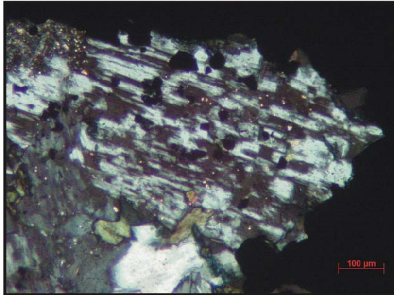
Figura 40 - Fotomicrografia de cristal de albita com textura tipo tabuleiro de xadrez. Amostra de magnetitito F-33/315,35m, corpo Sequeirinho. (Luz transmitida, nicóis X).
