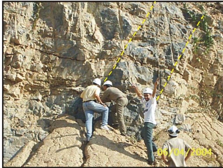
Figura 5 – Fotografia de frente de lavra de dique de rocha máfica de direção WNW-ESE cortando rocha granitóide, corpo Sequeirinho.
