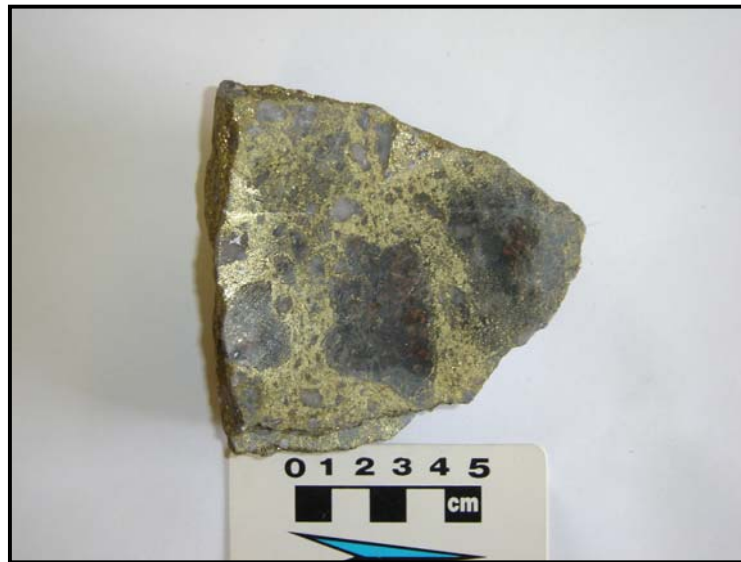
Figura 42 – Fotografia de amostra do minério de aspecto brechóide em que “clastos” angulosos de actinolita acham-se cimentados por calcopirita. Frente de lavra, corpo Sequeirinho.
