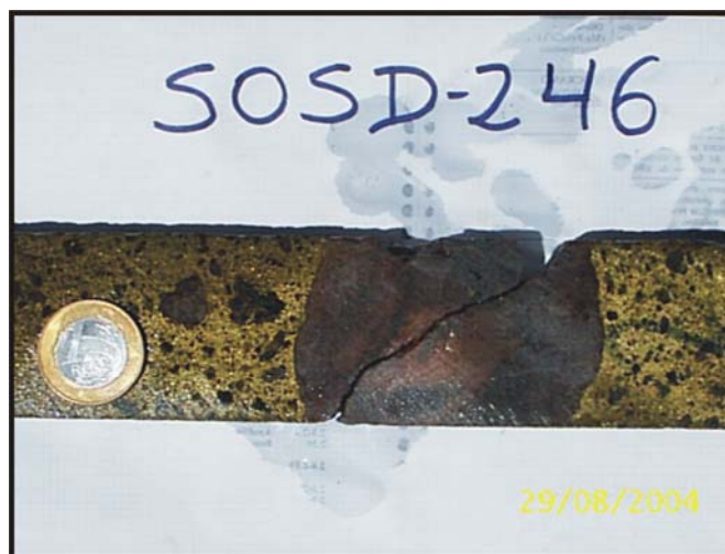
Figura 46 – Fotografia de testemunho de sondagem de brecha mineralizada do tipo Sossego, com destaque para um grande clasto arredondado de rocha granítica.
