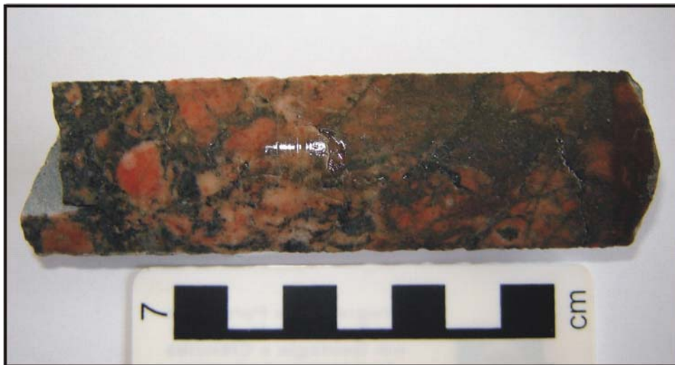
Figura 9 – Fotografia de testemunho de sondagem de rocha granítica, fortemente albitizada e de coloração avermelhada. Amostra F-110/91,5m, corpo Sequeirinho.
