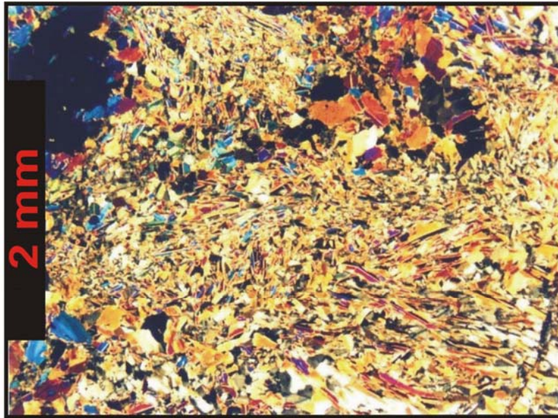
Figura 24 - Fotomicrografia de actinolítico típico, isótropo e formado essencialmente por cristais de actinolita de tamanhos variados. Amostra F-352/ 93,8m, corpo Sequeirinho. (Luz transmitida, nicóis X).
