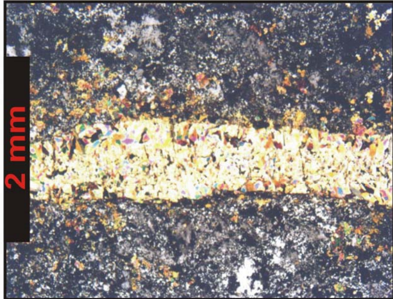
Figura 18 - Fotomicrografia de vênula monominerálica de epidoto cortando granitóide porfirítico. Amostra F-352/63,5m, corpo Sequeirinho. (Luz transmitida, nicóis X).
