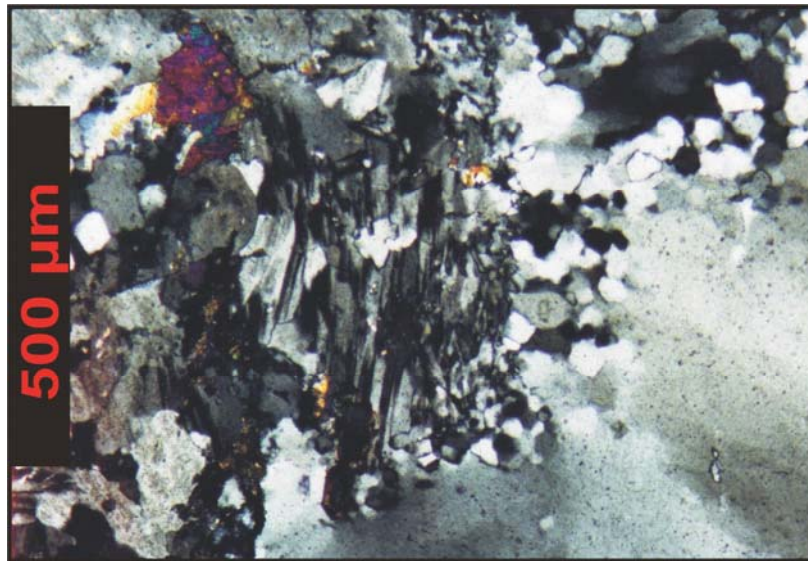
Figura 10 – Fotomicrografia de cristal de plagioclásio com textura tabuleiro de xadrez. Amostra F-51/70,3m, corpo Sequeirinho. (Luz transmitida, nicóis X).
