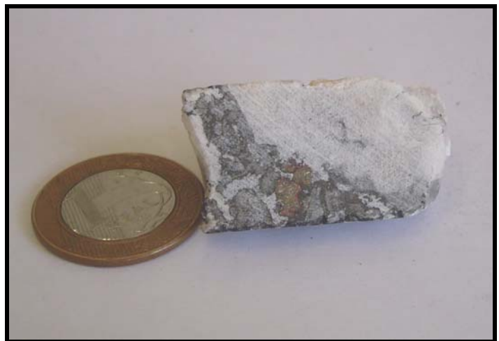
Figura 60 – Fotografia de testemunho de furo de sondagem de calcita em matriz de brecha. F288/185,7m -corpo Sossego.
