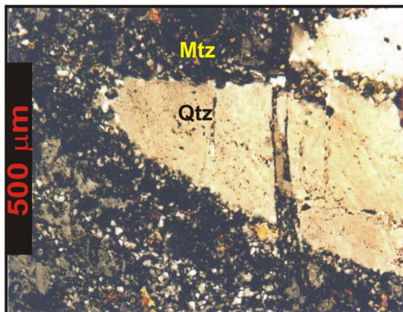
Figura 17 - Fotomicrografia de fenocristal de quartzo (Qtz) levemente estirado, com bordas corroídas e fratura preenchida por material da matriz (Mtz). Amostra de granitóide porfirítico. Amostra F-37/391m, corpo Sequeirinho. (Luz transmitida, nicóis X).
